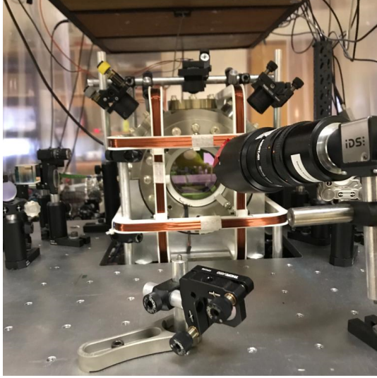
Figura 3. Foto de la MOT del laboratorio de física cuántica y atómica del IFFI. En el exterior se pueden apreciar las bobinas de corrección y la cámara monocromática que apunta al centro de la trampa.
